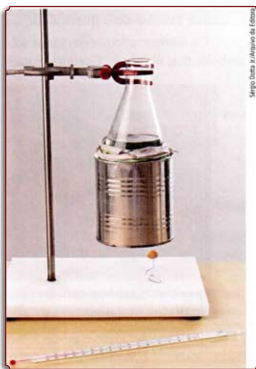
Figura 2-47: Montagem para a queima do amendoim. (volume 2, página 80)
